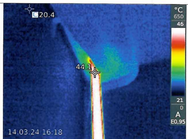
Фото 18. Термографические данные по стояку на первом этаже офисных помещений
