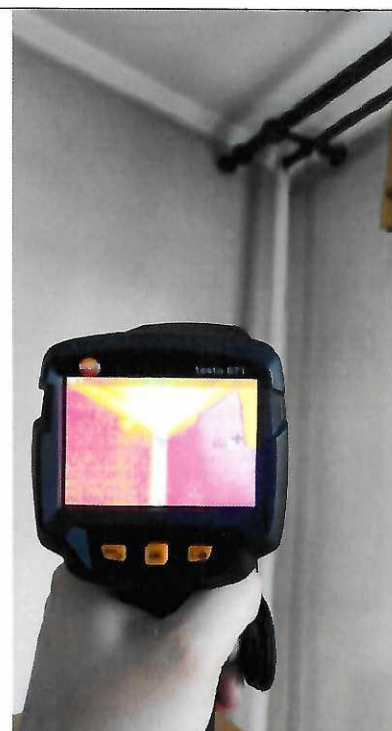
Фото 4. На момент измерения температура теплоносителя в квартире №200 была 44 °С
